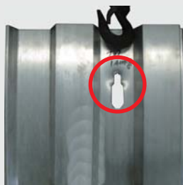
引抜作業での 破損
