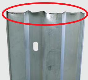
打込作業での 変形
