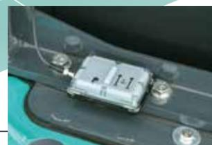
2Dセンサは水平面ならば機械本体のどこにも取り付け可能。
