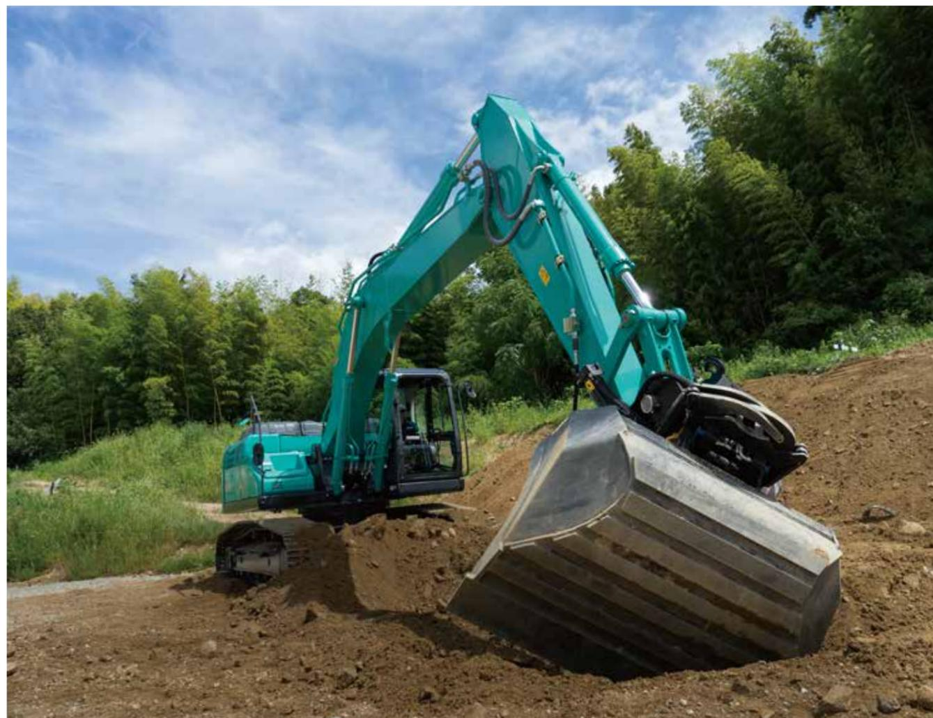
バケットのチルト動作を自動で制御。図面通りの高い精度で、自動切り出します。切り出し回数が減り、施工スピードが大きく向上します。
