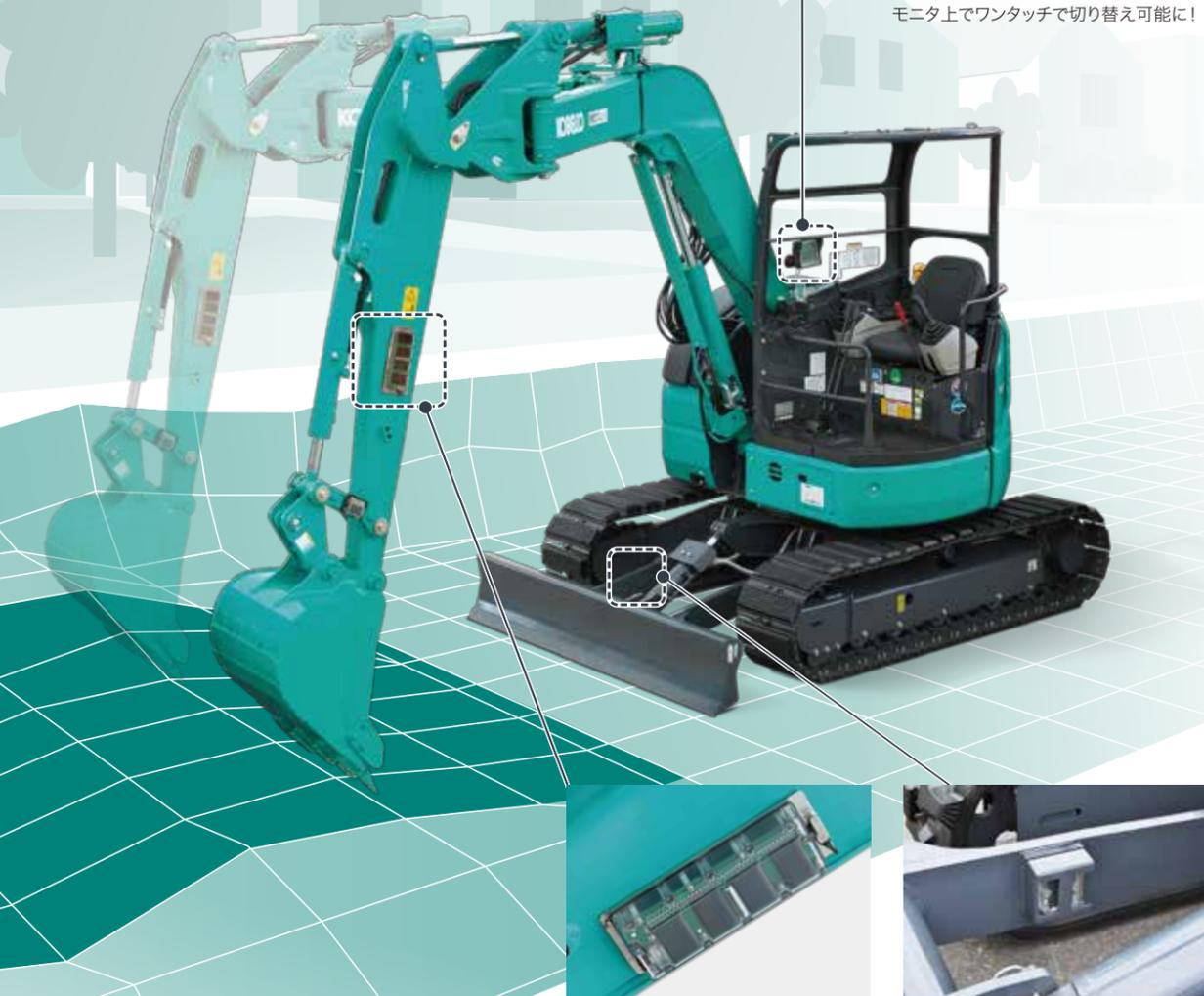
『iDig Dozer』用アームセンサを新たに開発。アームセンサのレーザー受光機能を利用してドーザ用マストが不要。
