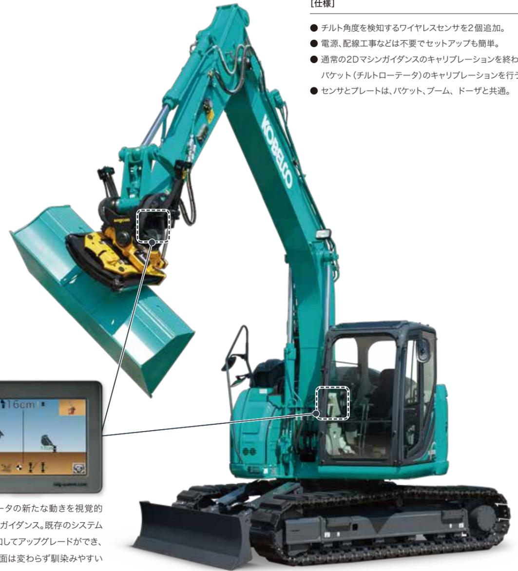
チルトローテータの新たな動きを視覚的にわかりやすくガイダンス。既存のシステムにセンサを追加してアップグレードができ、基本の操作画面は変わらず馴染みやすい設計。
