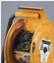
コードリールのドラム表面にコンセントを設置。電線を全部引き出し、コンセントカバーを開くと、コンセントが使用可能になります。コンセントカバーはバネ付きなので、電線巻き取り時にカバーが邪魔になることはありません。
