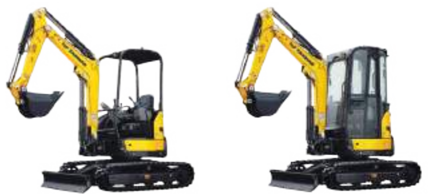
4柱キャノピー仕様(ROPS※1/FOPS※2基準)
